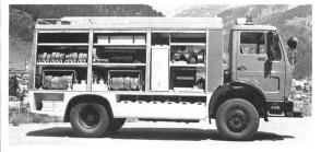
AF/36 in spezieller Feuerwehrausführung mit Allison-Getriebeautomat, Allradantrieb und serienmässiger Kippkabine mit Sitzplätzen für den Fahrer und zwei Beifahrer. Die kombinierte Löschanlage besteht aus zwei Druckkesseln für 500 kg Löschpulver Totalit 2000-ABCE und 500 l Light-Water-Mischung sowie aus zwei Pressluftflaschen zu 50 l und 200 bar Druck
