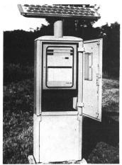
Pneumatische Wassermengenmess-Station, Temperaturmessung
