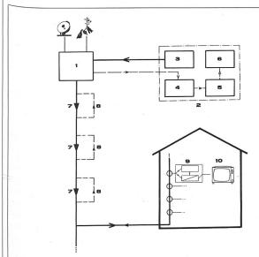
1 Kopfstation für den Empfang öffentlicher Programme, 2 Pay-TV-Zentrale, 3 Programmquellen, 4 Datenempfänger für Rückmeldedaten, 5 Computer, 6 Automatische Programmverrechnung, 7 Verstärker für Fernsehprogramme, 8 Verstärker für Rückmeldedaten, 9 Pay-TV-Kanverter mit Datensender, 10 Fernsehempfänger.
