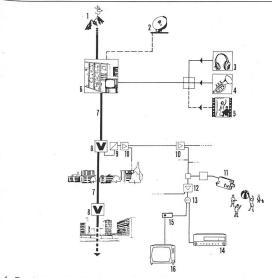
1 Empfangsturm für Fernempfang, 2 Parabolantenne für Richtstrahl- und Satellitenempfang, 3 Programmüberwachung, 4 Tonstudio, 5 Fernsehstudio, 6 Kopfstation, 7 HF-Primärschiene, 8 Primärverstärker, 9 HF-VHF-Umsetzer, 10 VHF-Streckenverstärker, 11 Fernsehkamera, 12 VHF-Verteilverstärker, 13 Anschlussdose, 14 Radioempfänger, 15 Programmwähler für mehr als 6 Programme, 16 Fernsehempfänger.
