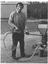
Exzenterschneckenpumpe roto 15.2 mit nachspannbarem Stator auf demontierbarem Karren zum Einbringen von Putz bei Altbausanierung.
