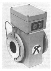
Hier kommt die bisher bekannte Wechselfeldschaltung zur Anwendung. Die Messung ist unabhängig von den Messstoffeigenschaften wie Dichte, Viskosität, Druck und Feststoffanteil. Keine vorstehenden oder beweglichen Einbauteile, glattes Innenrohr, kein zusätzlicher Druckverlust. Der Signalausgang ist proportional zur Durchflussgeschwindigkeit. Diese Gerätegruppe wird in den Nennweiten 25 bis und mit Nennweite 300 gefertigt und ist ab Lager lieferbar.
