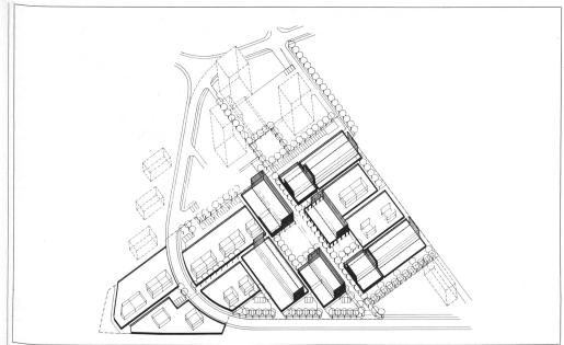
Öffentliche Aussenräume: Abgrenzung der hauptsächlichen öffentlichen Aussenräume durch architektonische Elemente (Hausfassaden, Stützenreihen, Gartenmauern und -zäune usw.). Festlegen des grundsätzlichen Verlaufs der zu erwartenden Bauvolumen auf einer hinteren Ebene durch Baulinien (Abb.: Atelier 5, Bern).
