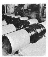
Isolierstücke NW 32'' ANSI 900 für Offshore-Betrieb.
