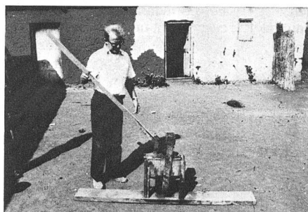
Handpresse zur lokalen Bausteinherstellung.
