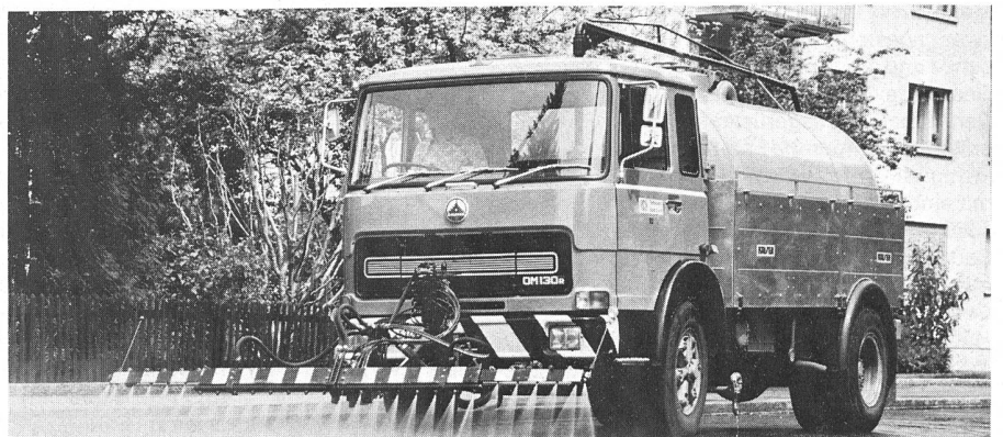
Saurer-OM-Lastwagen, Typ 130 R, mit Tank und Strassenreinigungsanbau ausgerüstet: Mit Tank und Strassenreinigungsanbau ausgerüstet, 13 t Gesamtgewicht und kleine Ausmasse prädestinieren den Saurer OM 130 R besonders für Aufgaben in der Strassenreinigung. Die Saurer-OM-Reihe umfasst ein Fahrzeugprogramm im Leistungsbereich von 3,5 bis 13 t und verfügt über besonders leise, sparsame und robuste Motoren.
