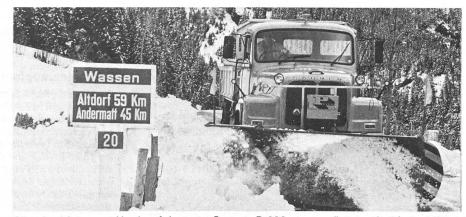
Allradgetriebenes Haubenfahrzeug Saurer D 290, ausgerüstet mit Pfadschlitten für Schneeräumungsarbeiten: Das Saurer-Nutzfahrzeugsortiment für den Winterdienst, im Leistungsbereich von 180 bis 330 PS, wird vor allem mit angebauten Pfadschlitten, Salz- oder Sandstreuvorrichtungen eingesetzt. Die leistungsstarken, umweltfreundlichen und sparsamen Motoren, eine robuste, langlebige Konstruktion und die besondere Wintertüchtigkeit sind die wesentlichen Merkmale dieser zuverlässigen Fahrzeuge.
