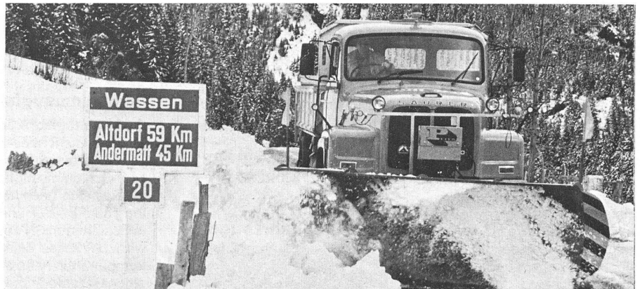
Allradgetriebenes Haubenfahrzeug Saurer D 290, ausgerüstet mit Pfadschlitten für Schneeräumarbeiten: Das Saurer-Nutzfahrzeugsortiment für den Winterdienst, im Leistungsbereich von 180 bis 330 PS, wird vor allem mit angebauten Pfadschlitten, Salz- oder Sandstreuvorrichtungen eingesetzt. Die leistungsstarken, umweltfreundlichen und sparsamen Motoren, eine robuste, langlebige Konstruktion und die besondere Wintertüchtigkeit sind die wesentlichen Merkmale dieser zuverlässigen Fahrzeuge.
