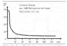
Abb. 2. Aus Emissionsdaten und Fahrzeugdichte berechnete CO-Konzentration am Strassenrand bei verschiedenen Fahrgeschwindigkeiten.
