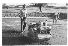
**DUOMAT-Doppelvibrationswalzen** mit Einsatzgewichten von 580 und 1250 kg. R 66 mechanisch, DR 66 hydrostatisch angetrieben.
