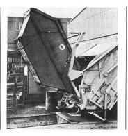
Eurotainer in Grossüberbauungen rasch an Ort und Stelle in Kehrichtfahrzeuge entleert werden. Das zusätzliche Hebesystem für Mulden und Eurotainers kann problemlos an jedes neue oder bereits im Einsatz stehende Kehrichtfahrzeug der Typen Colectomatic Mark IV und Mark V von 15 bis 19 m³ Fassungsvermögen angebaut werden sowie auch an Modelle von nur 2,3 m Breite. Der Muldex zeichnet sich durch
