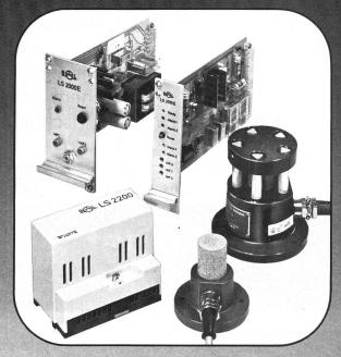
erkennen rechtzeitig auftretende Gefahren. Gaswarngeräte LS dienen zur Erfassung von Erdgas, Stadtgas, Wasserstoff, Alkoholdämpfen, Azetylen, Aethan, Propan, Butan, Kohlenmonoxyd usw. in Mischung mit Luft.
