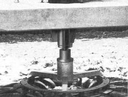
KISSLING-Getriebe mit verlängerter Nabe und automatischer Höhenverstellung.
