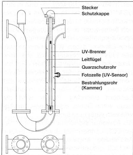
durch spezielle Leitflügel am Innern des Bestrahlungsrohrs der Anlage maximiert, indem das Wasser während des Durchflusses umgewälzt wird. Die Mikroorganismen kommen mehrere Male unmittelbar an die Lichtquelle heran, was bei einem laminaren Durchfluss (also ohne Leitflügel) nicht der Fall wäre. Das Multus-Entkeimungsprogramm reicht somit von 8 l pro Minute bis zu jeder gewünschten Leistung für Gross-Wasserversorgungen. Wenn die Gerätespezifikation mit dem der Anlage eigenen UV-Brenner sowie
