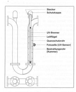
durch spezielle Leitflügel am Innern des Bestrahlungsrohres der Anlage maximiert, indem das Wasser während des Durchflusses umgewälzt wird. Die Mikroorganismen kommen mehrere Male unmittelbar an die Lichtquelle heran, was bei einem laminaren Durchfluss (also ohne Leitflügel) nicht der Fall wäre. Das Multus-Entkeimungsprogramm reicht somit von 8 l pro Minute bis zu jeder gewünschten Leistung für Gross-Wasserversorgungen. Wenn die Gerätespezifikation mit dem der Anlage eigenen UV-Brenner sowie
