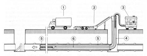
Abb. 1. Insituform-Relining 1 Kühlwagen; 2 Förderband; 3 Pump- und Heizaggregat; 4 Inversionsrohr; 5 Mit Polyester getränkter Filzschlauch; 6 Heisswasserschlauch
