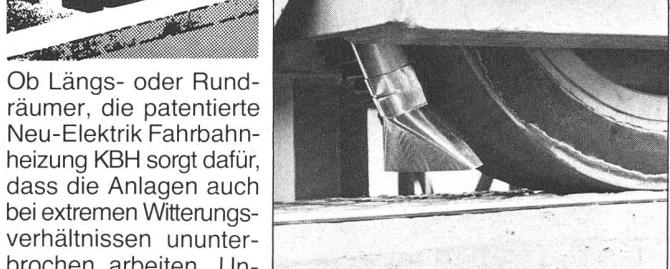
Ob Längs- oder Rundräumer, die patentierte Neu-Elektrik Fahrbahnheizung KBH sorgt dafür, dass die Anlagen auch bei extremen Witterungsverhältnissen ununterbrochen arbeiten. Unmittelbar vor die Laufräder geblasene Heissluft taut Schnee und Eis
