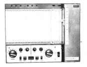
Der Minigor 510 eignet sich besonders für den transportablen Einsatz, etwa für Messungen in Fahrzeugen, Flugzeugen, Schiffen, in der Sportmedizin und Analysentechnik, wo ausser einer handlichen und netzunabhängigen Ausführung hohe Anforderungen an die Robustheit und Funktionssicherheit gestellt werden.
