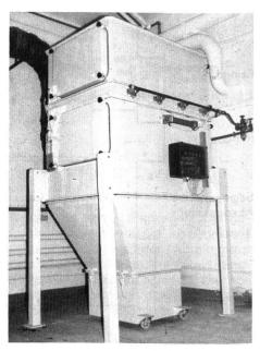
Abb. 2. ANKE-Filtersystem, Einzelentstauber PR 30.
