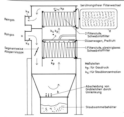
Abb. 1. Filteranlage zur Feinstfiltration von Gasen mit hoher Staubbeladung.
