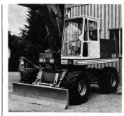
Arbeitsgeschwindigkeiten sowie volle Ausbruchkraft. Auffallend ist die saubere Leistungsführung der gesamten Hydraulikanlage. Grosse Fensterflächen gewähren eine ungehinderte Sicht nach allen Seiten. Übersichtlich angeordnete Armaturen und die leicht zu handhabende Zweihebelbedienung erleichtern dem Fahrer die Arbeit.
