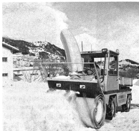
Bucher GT 1200 mit Peter-Schneefräse Typ 850/1500. Fräse in der Seitenneigung hydraulisch verstellbar. Fahrzeug mit VW-Motor, 70 DIN-PS, hydrostatischer Fahrtrieb 0-40 km/h. Differentialsperre vorn und hinten, Zapfwelle vorn und hinten, Nutzlast bis 1700 kg, Breite 125 mm, Länge 3500 mm, Höhe 2050 mm.
