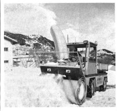
Bucher GT 1200 mit Peter-Schneefräse Typ 850/1500. Fräse in der Seitenneigung hydraulisch verstellbar. Fahrzeug mit VW-Motor, 70 DIN-PS, hydrostatischer Fahrantrieb 0–40 km/h. Differentialsperre vorn und hinten, Zapfwelle vorn und hinten, Nutzlast bis 1700 kg, Breite 125 mm, Länge 3500 mm, Höhe 2050 mm.
