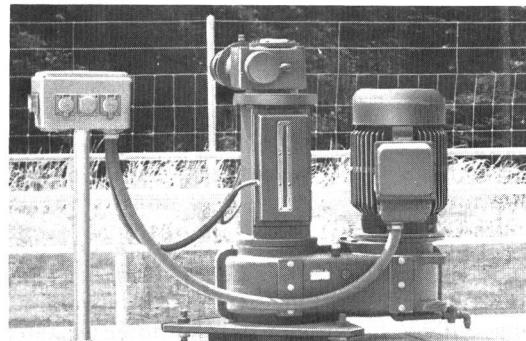
**KISSLING-Getriebe mit verlängerter Nabe und automatischer Höhenverstellung.**
