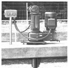
KISSLING-Getriebe mit verlängerter Nabe und automatischer Höhenverstellung.
