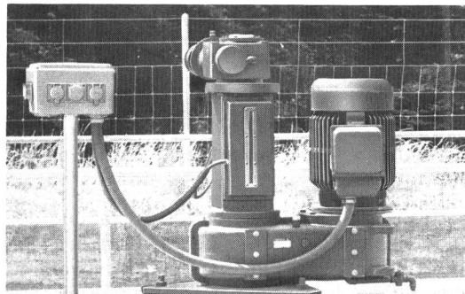
**KISSLING-Getriebe mit verlängerter Nabe und automatischer Höhenverstellung.**
