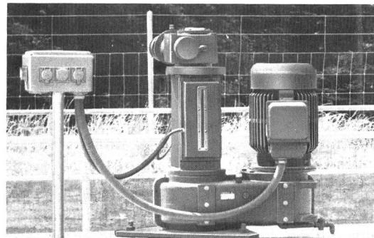
**KISSLING-Getriebe mit verlängerter Nabe und automatischer Höhenverstellung.**
