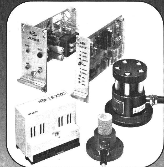
erkennen rechtzeitig auftretende Gefahren. Gaswarngeräte LS dienen zur Erfassung von Erdgas, Stadtgas, Wasserstoff, Alkoholdämpfen, Azetylen, Aethan, Propan, Butan, Kohlenmonoxid usw. in Mischung mit Luft.
