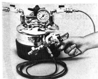
Der Filterjetdispenser Millipore für Lösungsmittel enthält einen integrierten 25-mm-Filterhalter, in den ein Millipore-Membranfil-
