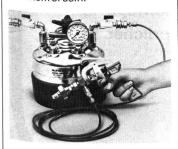
Der Filterjetdispenser Millipore für Lösungsmittel enthält einen integrierten 25-mm-Filterhalter, in den ein Millipore-Membranfilter eingesetzt wird. Das Lösungsmittel liegt in einem Druckbehälter vor und wird durch die Membran filtriert, wodurch ein ultrareines Medium zum Reinigen und Spülen direkt am Verwendungsort vorliegt.
