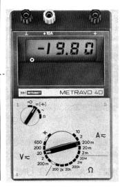
bis 250 V ≈ in allen Messbereichen (ausser 10-A-Bereich). Die robuste Konstruktion gewährleistet, insbesondere mit einer Gummischutzhülle, einen weitgehenden Schutz bei rauher mechanischer Beanspruchung. Das Gerät arbeitet netzunabhängig mit handelsüblichen Mignonzellen. Der Stromverbrauch ist dank den elektronischen Bausteinen in LSI-Technik und der Flüssigkristallanzeige ausserordentlich gering. Abmessungen: 110×181×62 mm, Gewicht 750 g einschliesslich Batterien.
