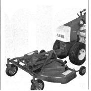
Einachstraktoren Aebi AM 8 und AM 15 mit Geräten zum Hacken, Mähen, Mulchen, Transportieren, Schneeräumen, Spritzen
