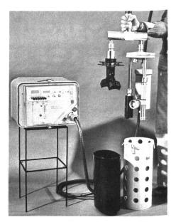
Abb. 2. Hydropolytester, System Züllig, zur elektrischen Messung von Sauerstoff, elektrischer Leitfähigkeit, pH, Temperatur, Trübung und Sondentiefe bis 300 m Wassertiefe.
