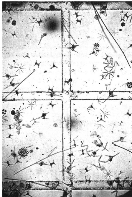
Abb. 9. Auszählung der Planktonorganismen in der Zählkammer. Blick durch das Mikroskop auf die Zählplatte.
