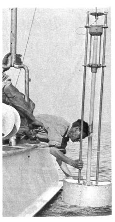
Abb. 17. Raumkolbenlot, System Züllig, zur Entnahme nicht zusammengestauchter Bohrkerne bis mehrere Meter Länge.
