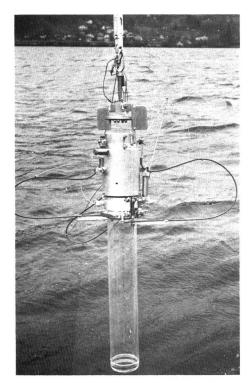
Abb. 16. Sedimentgrossprobennehmer, nach Ambühl [4], zur Entnahme von kurzen Sedimentkernen. Gerät mit hochgezogenem Verschlussmechanismus, der beim Hochziehen des Bohrkernes die Röhre unten abschliesst und auch die Entnahme sandiger und lockerer Sedimente ermöglicht.
