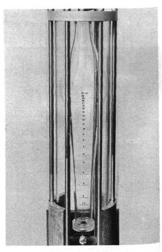
Abb. 11. Summierender Wasserschöpfer, nach Schröder, zur gleichvolumigen Entnahme von Wasserproben aus allen Wassertiefen für eine Sammelprobe.
