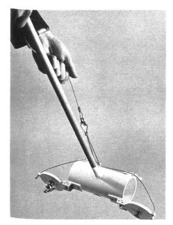
Abb. 12. Horizontalschöpfflasche, nach Ambühl und Zimmermann [5], zur Entnahme von Wasserproben aus fliessenden Gewässern.
