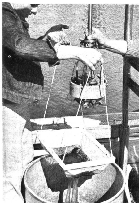
Abb. 13. Bodengreifer, nach Auerbach, und Auswaschen gefasster Schlammproben im Schlammsiebnetz zur Erkundung der tierischen Besiedlung am Gewässergrunde.
