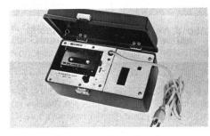
Abb. 6b. Transportabler Datalogger zur Speicherung der elektrischen Messwerte, Fabrikat EDMAC Associates Inc.
