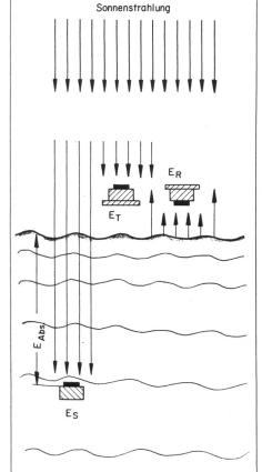
Abb. 5. System der Lichtmessung in Oberflächengewässern. Beim Messen des einfallenden Lichtes wird das an der Wasseroberfläche reflektierte Licht in Abzug gebracht.
