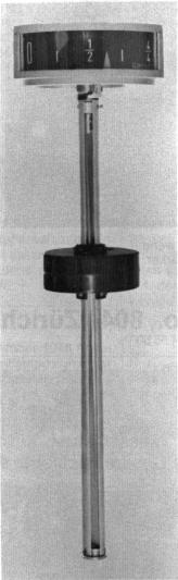
benutzen, indem man vier Reedkontakte einbaut. Diese sind in solide Gehäuse eingegossen, können mit 100 VA belastet und von Hand auf die gewünschte Niveauhöhe eingestellt werden. Und drittens kann man ein Potentiometer mit Spannungsstabilisator einbauen, worüber eine Fernanzeige gesteuert werden kann.
