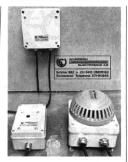
Flüssigkeiten an. Ein Sensor, montiert im Gehäuseinnern, überwacht den Zwischenraum von Auflage (Boden) zu Geräteunterseite. Der Sensor kommt mit der Flüssigkeit nicht in Berührung, sondern «tastet» durch den Gehäuseboden hindurch. Erfasst werden: Wasser, Öl, Chemikalien, Milch, Alkohol, Regen, dünn- oder dickflüssige Medien.
