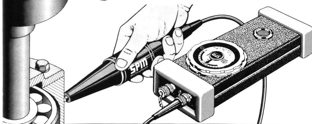
Wälzlagerkontrolle mit der SPM-Methode ist einfach, zuverlässig und hat sich weltweit bewährt.
