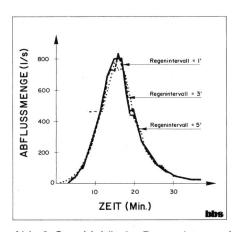
Abb. 8. Sensitivität der Regendaten auf den Abflusshydrographen des Testgebietes Länggasse.
