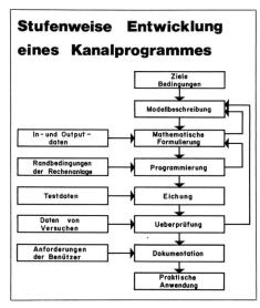
Abb. 6. Vorgehensschema bei der Entwicklung eines Kanalprogrammes.
