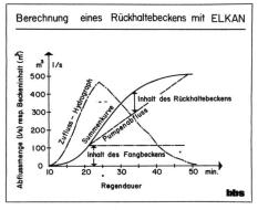
Abb. 14. Bestimmung des erforderlichen Inhaltes eines Rückhaltebekkens aus dem Zu- und Abflusshydrographen.
