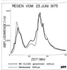
Abb. 9 und 10. Testgebiet Länggasse Bern, gemessene und gerechnete Abflusshydrographen.
