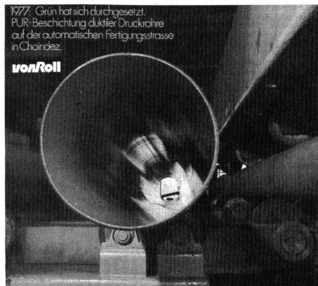
Von Roll-Rohre aus duktilem Gusseisen, innen PUR (Polyurethan)
