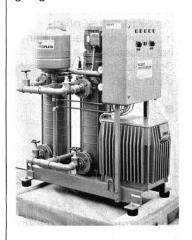
Die Hochdruckpumpen sind ebenfalls gegen Korrosion geschützt, denn die Stufenstücke, die Laufräder und die Welle sind aus rostfreiem Stahl gefertigt. Ebenfalls neu sind die einschaufligen Pumpen in Blockbauweise, wo Pumpe und Motor zusammengebaut sind. Die Hydroplus-Anlagen haben sich bestens bewährt. Ausgestellt ist ein Hydroplus E, ein mittels Frequenzumformung drehzahlreguliertes Aggregat (siehe Abb.). Davon sind fünf Stück in der
