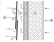
werden Wärmedämmung und Aussenwand vor allen Witterungseinflüssen (5) geschützt. Im Belüftungsraum (2) kann der vom Gebäudeinneren ausgehende Wasserdampf (6) ungehindert abgeführt werden. Alle Fassadensysteme «Eternit» beruhen auf dem Prinzip der vorgehängten Wetterhaut. Für die Verkleidung stehen die verschiedensten Formate und Farben zur Verfügung, so dass jedem Gebäudetyp ein ansprechendes Äusseres verliehen werden kann.
