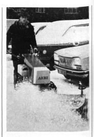
hohen Leistung ist die SF 2 dank Differential mit Sperre und Lenkbremsen leicht zu handhaben. Die Hochleistungsbatterie garantiert auch im tiefsten Winter einen sicheren Start.
