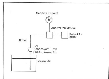
Bei der kapazitiven Messung wird eine Messsonde direkt ins Wasser geführt. Dabei wird die Eintauchtiefe der Sonde als kapazitive Änderung in der Elektronikeinheit ausgewertet. Mit den nachgeschalteten Kontaktgebern kann bei einer eingestellten Eintauchtiefe ein Relaiskontakt betätigt werden, oder das Niveau kann zusätzlich auf einem Instrument oder Schreiber registriert werden.
