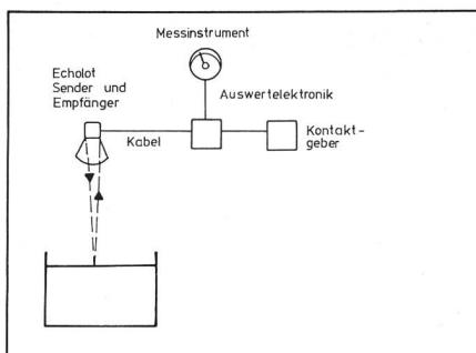
Beim Echolotverfahren wird ein Schallimpuls gesendet und die Laufzeit, bis der Impuls als Echo vom Medium zum Sendegerät zurückkehrt, gemessen. In der Elektronikeinheit wird diese Zeiteinheit ausgewertet. Mit den nachgeschalteten Kontaktgebern kann bei je-
