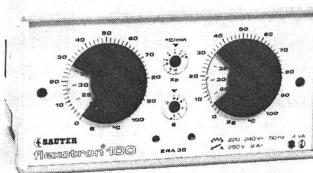
6 zusätzliche Regler – Kompaktgehäuse 72 × 144 (nach DIN 43700) IP 32 für Auf- und Einbau mit Stecksockel für problemlosen elektrischen Anschluss – direkter Netzanschluss für 220 ... 240 V, 50 Hz – einfache Inbetriebsetzung und wartungsfrei – Verwendung der bereits im Sortiment vorhandenen und bewährten Fühler und Stellgeräte mit reversierbaren Motorantrieben.
