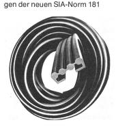
entspricht. Mit nur 6 mm Stärke erreicht sie Spitzendämmwerte von +24 dB(A). Die Temperaturbeständigkeit reicht von -50 bis +120 °C. Die Einlage wird sowohl in Rollen als auch fertig ausgelegt in Rohrschellen oder Briden geliefert. Für Lüftungskanäle stehen spezielle Dämmgulast-Scheiben zur Verfügung.
