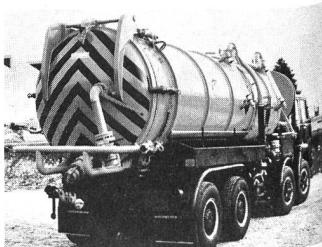
Ausstossplatte. Entleerungs-klappe hydraulisch nach oben öffnend und mit hydraulischer Verriegelung. Zur Evakuierung der Schlammkammer sind zwei Vakuumpumpen, wassergekühlt, Ansaugleistung 1420 m³/h, eingebaut.
