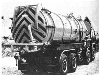
Ausstossplatte. Entleerungs-klappe hydraulisch nach oben öffnend und mit hydraulischer Verriegelung. Zur Evakuierung der Schlammkammer sind zwei Vakuumpumpen, wassergekühlt, Ansaugleistung 1420 m³/h, eingebaut.
