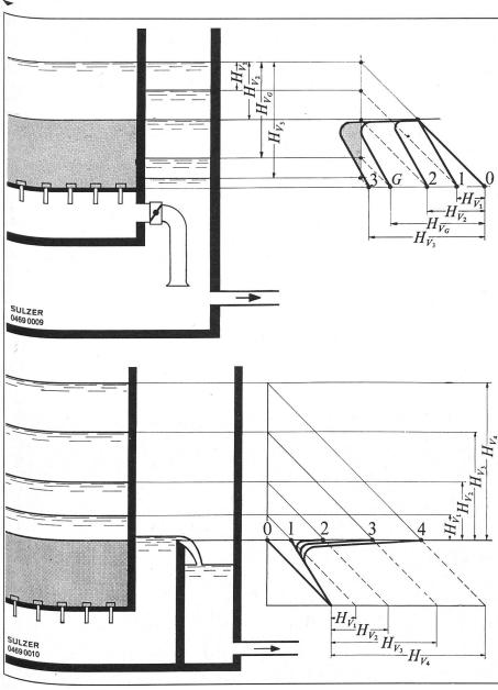
In der dritten Phase (ohne Spülluft) schwemmt schliesslich der verbleibende Wasserstrom die Verunreinigungen aus der Filtermasse.
