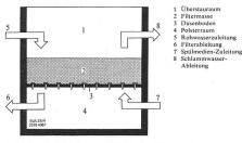
1 Schema der Filtration mit Hilfe körniger Massen.
