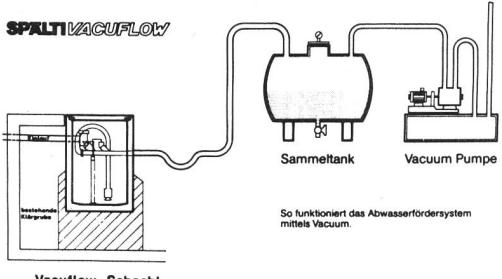
Spälti-Vacuflow fördert das Abwasser mittels Vakuum ohne Änderung der bestehenden Sanitärinstallationen!
