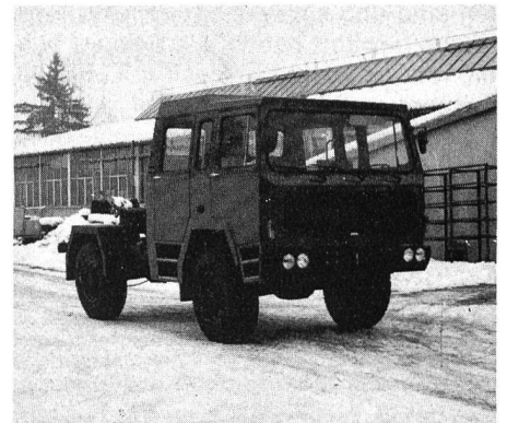
SAB 322 BL, kippbare Doppelkabine, 216-PS-Benzinmotor Ford V8 mit automatischem Getriebe, Radstand 3,0 m, Gesamtgewicht 6850 kg, Nutzlast 3150 kg
