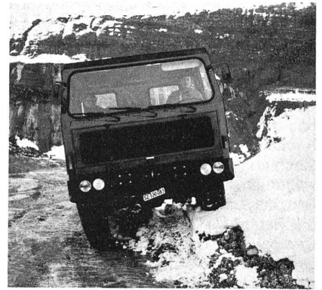
Der Vorteil der Einzelradaufhängung mit Luftfederung zeigt sich hier in der ausgezeichneten Anpassung an das Gelände
