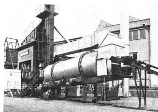
den einzelnen Maschinengruppen aufgebaut. Steckbare Steuerkabel verbinden die Maschinen und das Steuerpult in der Kommandokabine. Eine Generatorgruppe sorgt für eine unabhängige Stromversorgung. Die Firma bietet zwei Varianten an:
