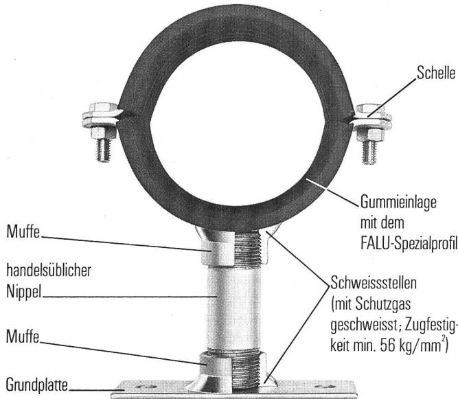
Dank dem Schutzgas-Schweißverfahren, bei dem wir Schweißmaterial von hoher Qualität und mindestens 56 kg/mm<sup>2</sup> Festigkeit an den Schweißstellen zuführen, können FALU-Rohrschellen einer hohen Belastbarkeit ausgesetzt werden.
