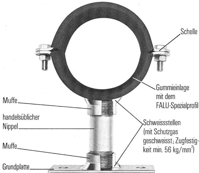
Dank dem Schutzgas-Schweissverfahren, bei dem wir Schweißmaterial von hoher Qualität und mindestens 56 kg/mm<sup>2</sup> Festigkeit an den Schweißstellen zuführen, können FALU-Rohrschellen einer hohen Belastbarkeit ausgesetzt werden.
