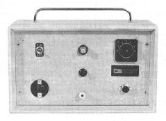
für Spannungen bis 35 000 Volt zur Prüfung von Beschichtungen erhalten Sie inkl. Lederkoffer zu nur Fr. 1400.–.
