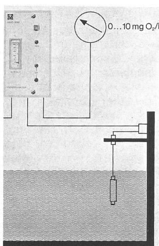
der Sonde DO 910, einer Spezialsteckdose und dem Sauerstoff-Messumformer AMO 9180.
