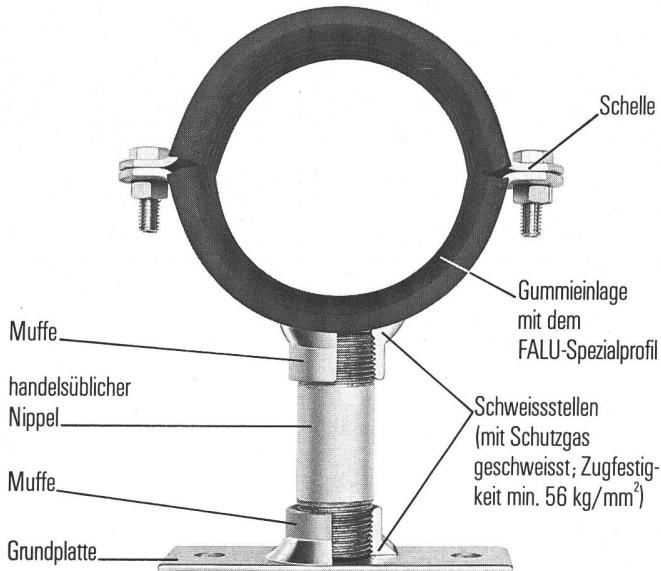
Dank dem Schutzgas-Schweissverfahren, bei dem wir Schweissmaterial von hoher Qualität und mindestens  $56 \text{ kg/mm}^2$  Festigkeit an den Schweißstellen zuführen, können FALU-Rohrschellen einer hohen Belastbarkeit ausgesetzt werden.
