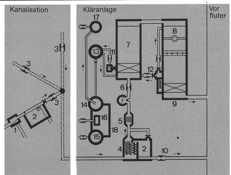
Der risikolose Betrieb einer Abwasserreinigungsanlage erfordert eine Ausrüstung von überdurchschnittlicher Betriebssicherheit. Das abgestimmte System von Kanälen, Klärbecken, Schiebern, Pumpen, Gasbehältern usw. muss aber auch lückenlos und zuverlässig überwacht und gesteuert werden. Nur so ist ein zweckmässiges Zusammenspiel aller Einrichtungen gesichert. Und dazu braucht es eine erstklassige Mess-, Steuer- und Regelungsanlage, zugeschnitten auf die Gegebenheiten der Anlage.
