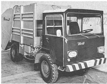
Meili MA-4000 mit einem Moser-Kehrichtaufbau für Berggemeinden. Grösste Breite nur 185 cm! 80-PS-Dieselmotor, 5-Gang-Getriebe mit Reduktionsgetriebe, Allradantrieb und Differentialsperre zuschaltbar
