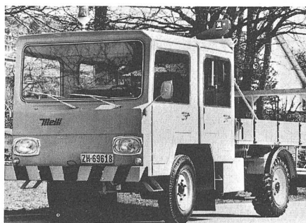
Meili M-1500 mit Doppelkabine und Ladebrücke mit Master-Kran für den Kommunaleinsatz. 50-PS-Perkins-Dieselmotor, heizbare Windschutzscheibe, gefederter Fahrersitz
