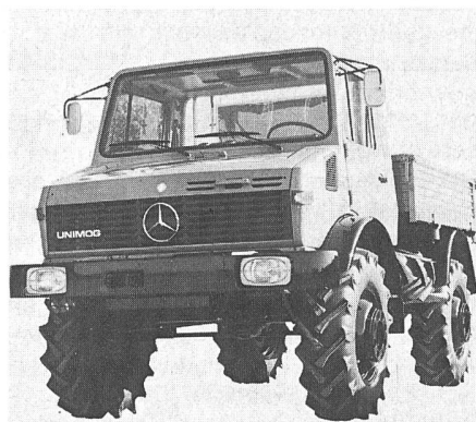
Der neue Unimog 425 mit 125-PS- Dieselmotor
