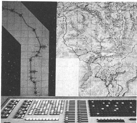
▷ Moderne Kommandozentrale zur Speicherung und Anzeige von Informationen. Leuchtschaltbild in Form einer topografischen Karte und eines Strassenschemas, ausgeführt in duroplastischem Kunststoff mit grossem Oberflächenschutz. Vielseitige Gestaltungsmöglichkeiten kennzeichnen das neue SKP-System für Blindsightsbilder und Displays.
