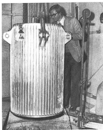
Absenken eines der neuen Quellenbehälter in den Bestrahlungsschacht der Gammabestrahlungsanlage in Geiselbullach (Sulzer Pressefoto)
