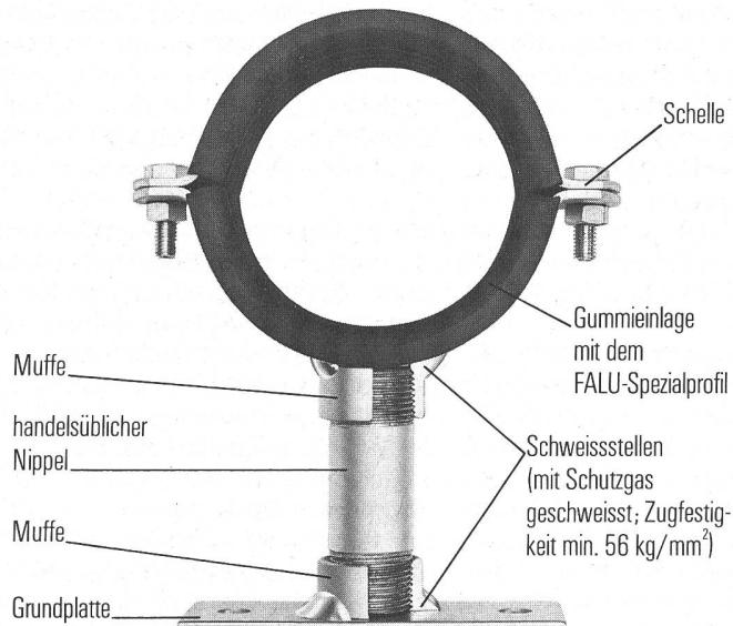
Dank dem Schutzgas-Schweißverfahren, bei dem wir Schweissmaterial von hoher Qualität und mindestens  $56 \text{ kg/mm}^2$  Festigkeit an den Schweißstellen zuführen, können FALU-Rohrschellen einer hohen Belastbarkeit ausgesetzt werden.
