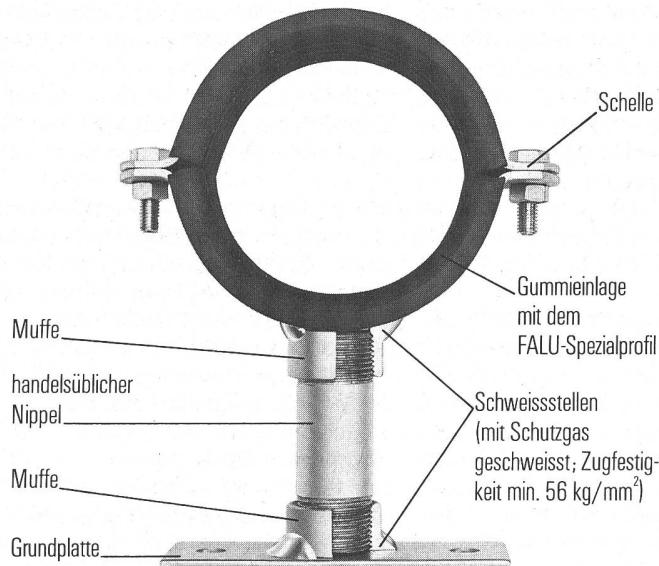
Dank dem Schutzgas-Schweißverfahren, bei dem wir Schweißmaterial von hoher Qualität und mindestens  $56 \text{ kg/mm}^2$  Festigkeit an den Schweißstellen zuführen, können FALU-Rohrschellen einer hohen Belastbarkeit ausgesetzt werden.
