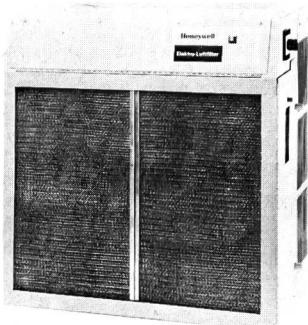
Die Arbeitsweise des F 54 C besteht darin, die Luft mittels eines 3-Gang-Ventilators durch einen Metallsieb-Vorfilter und einer elektronischen Zelle anzusaugen. Dieser Vorfilter fängt Partikeln auf, die mit bloßem Auge erkennbar sind, wie Fäden und Russelchen. Die elektronische Zelle besteht aus zwei Kammern. In der ersten Kammer werden die Partikeln elektrostatisch geladen, und in der zweiten
