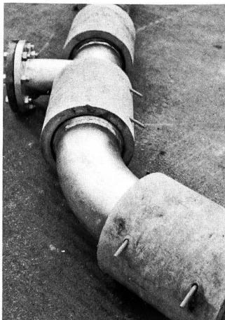
Formstücken in Druckrohrleitungen verwendet. Es stehen im Nennweitenbereich 200–2000 mm und für Nenndrücke bis 16 atü sämtliche Formstücke auch für die längskraftschlüssige Ausführung (Abb.) zur Verfügung.
