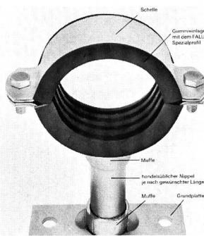
Weiter hat die Firma eine zusätzliche Universal-Rohrschelle mit einer 10-mm-Spezialgummieinlage in ihr Programm aufgenommen. Diese neue Rohrschelle für Schallschutzisolation ist speziell gedacht für leichtere Befestigungen mittels Holzschraubeneinsatz, Gewindestange für Wandmontage (speziell Kunststoffrohre) oder für die Bändliaufhängung mit Ösenbeschlägen an der Decke und an der Schelle.
