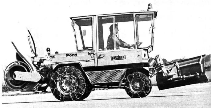
Palette von Zusatzgeräten steht zur Verfügung; diese dienen zum Schneefräsen, Schneeverladen, Salz- und Splittstreuen, Rasenmähen, Abschwemmen und Kehren von Trottoirs, Rasen- und Laubsaameln, Rasenbelüften, und schliesslich eignet sich das Pony auch für den Warentransport. Der Motor leistet 45 PS, die Kabine ist heizbar. Das Leergewicht beträgt etwa 300 kg, die Nutzlast respektabel 1900 kg. Es handelt sich um
