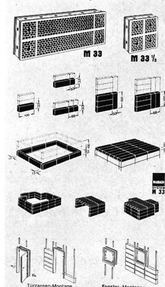
Technische Daten: Länge 100 cm, Höhe 33 cm, Dicke 17 cm. Das mittlere Schalldämmmaß nach DIN 52 210, Blatt 4, beträgt 27 bzw. 30 dB(A); Schallabsorptionsgrad etwa 0,95. Mit Bohrungsrauster (17 cm) für Rohrsteckverbindung an den Schmalseiten. Alleinvertretung für die Schweiz:
