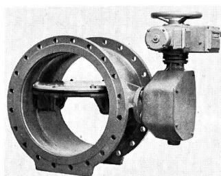
Bei der neu entwickelten exzentrisch gelagerten VAG-ROOR-Absperrklappe ist es gelungen, die Dichte-Effekte einer zentrisch und exzentrisch gelagerten Klappe zu vereinen. Die Weichdichtung der VAG-ROOR-Absperrklappe ist an der Klappenscheibe angeordnet. Als bemerkenswert darf der glatte rohrartige Gehäusedurchgang bezeichnet werden, der keine bearbeiteten Dichtflächen aufweist. Durch die harte Gusshaut wird ohne besondere Zusatzmittel eine
