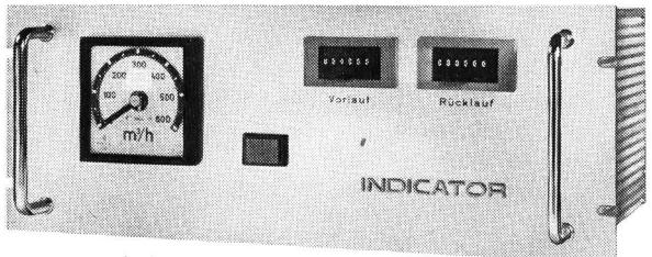
Digital-Analog-Umformer, für Messungen in zwei Richtungen den Richtungsgeber sowie die entsprechenden Summier- und Anzeigegeräte.
